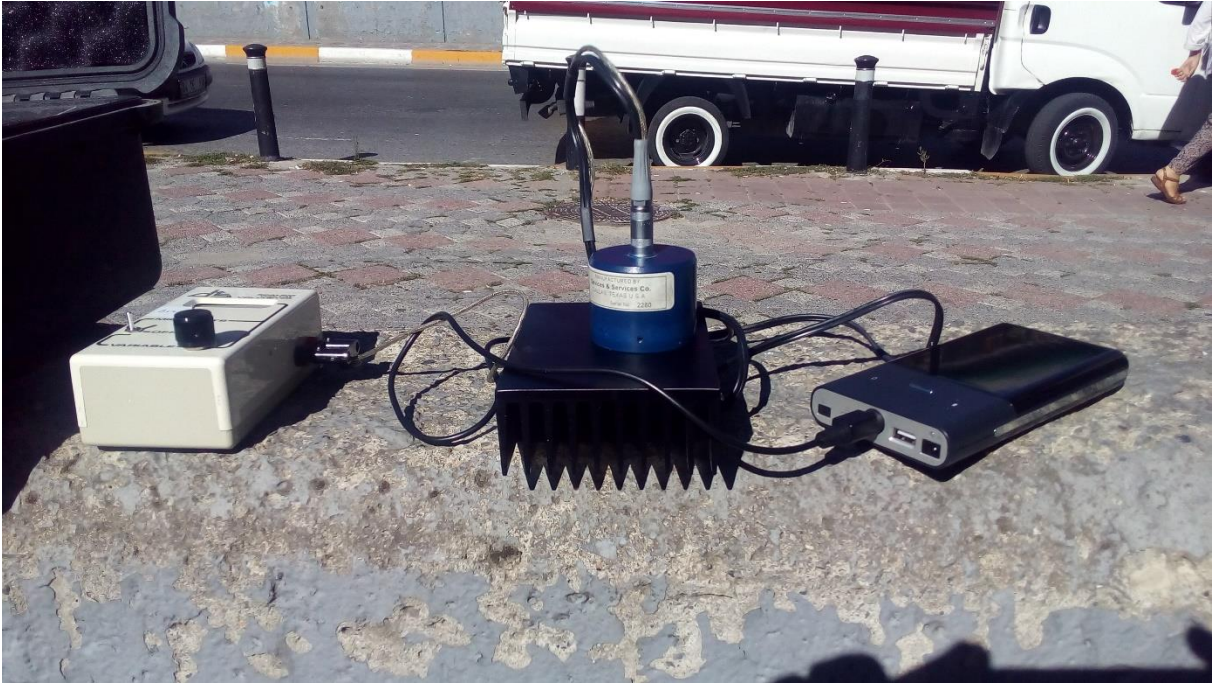
Şekil 5: Yüzey yayıcılığını ölçen cihazın hazırlanma aşaması
