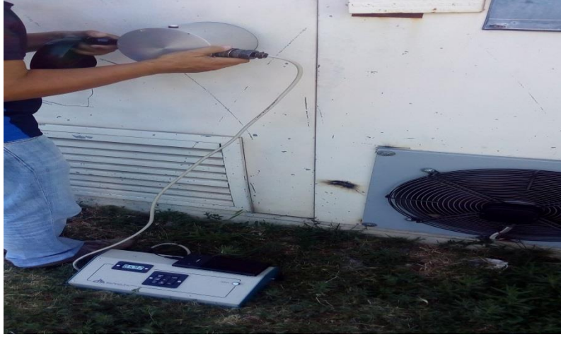
Şekil 4: Örnek yüzey yansıtıcılığı ölçümü
